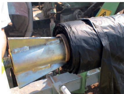
Figura 10. Adaptador troncocònic per poder treballar amb bobines amb diferents diàmetres interns.
