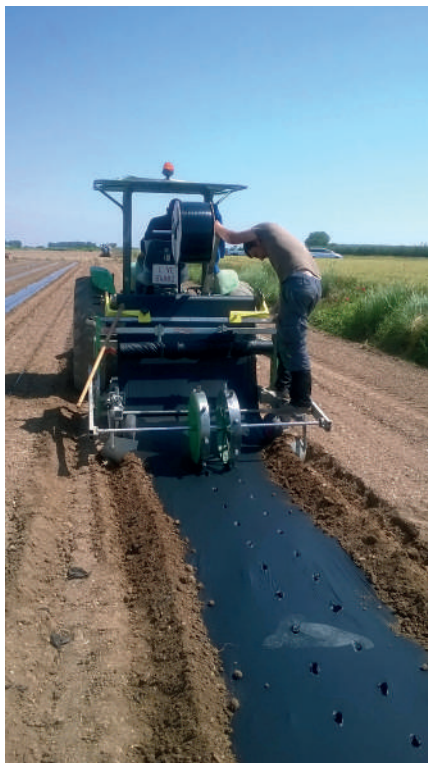
Figura 15. Perforació mecànica de la pel·lícula plàstica.
