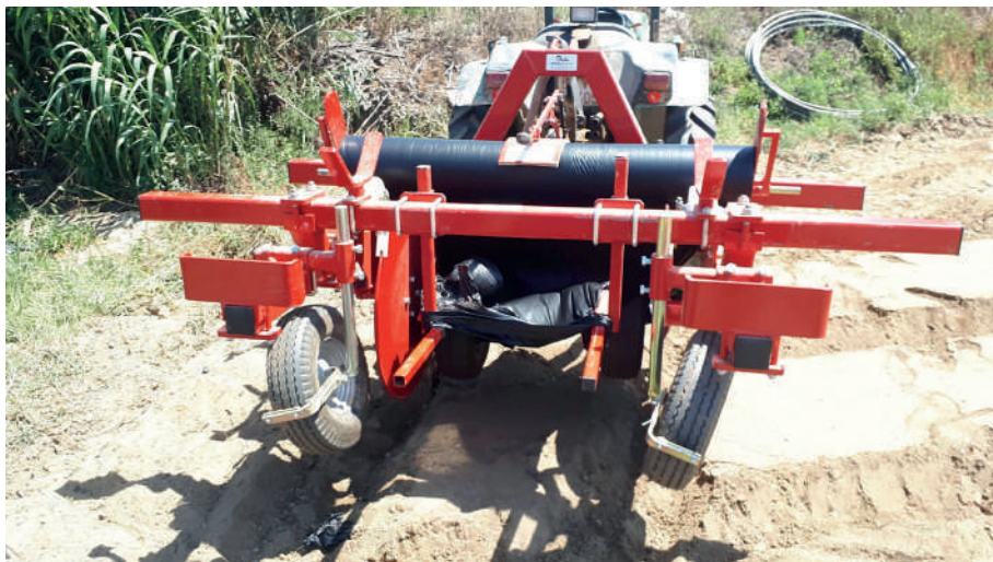
Figura 4. Màquina per encoixinar amb discs laterals per enterrar l'encoixinat.
