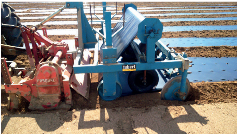
Figura 2. L'encoixinat s'instal·la al mateix temps que es fresa el camp.
